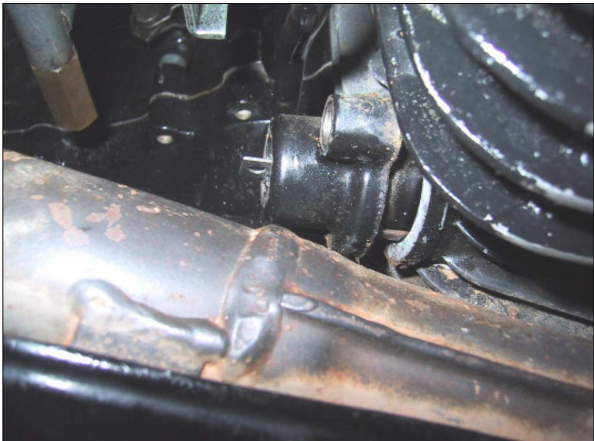
Am Spanner hinten mittig erkennt man ein selbstgefickeltes Werkzeug, mit dem man den Stempel entspannen kann. Das ist für den Einbau notwendig, da der Motor innerhalb weniger Meter zerstört wäre, wenn man den Steuerkettenspanner komplett ausgefahren einbauen würde
